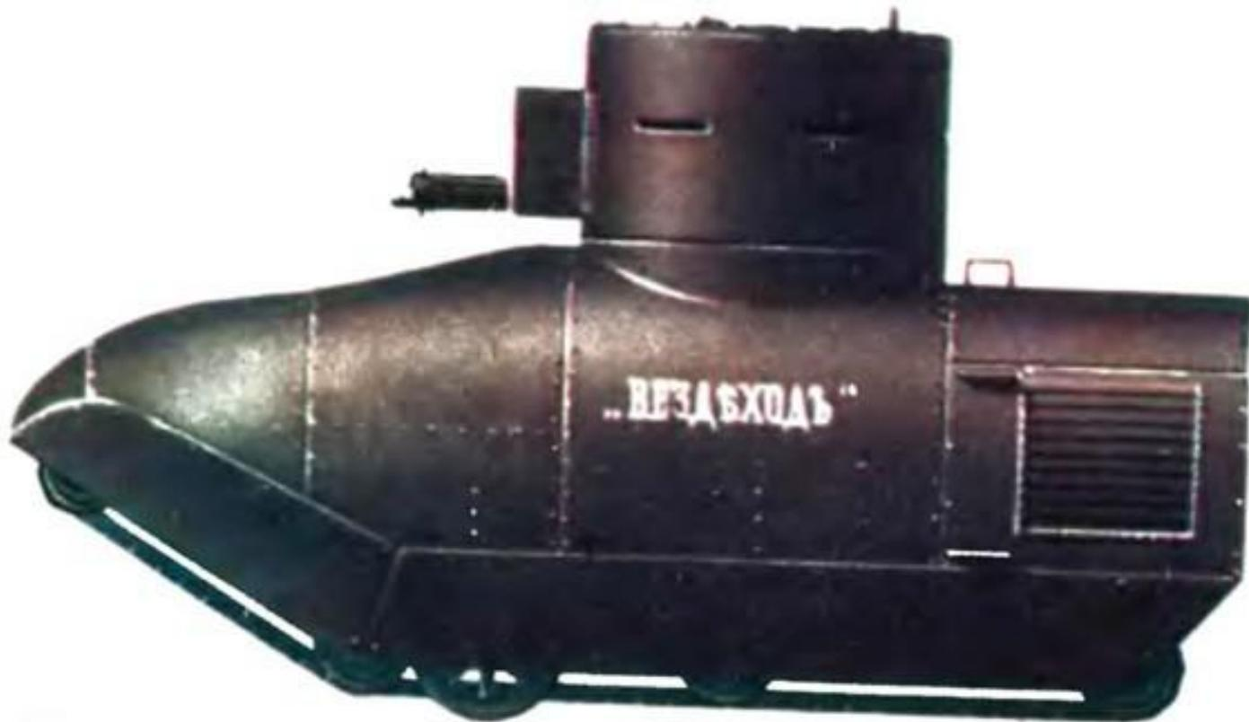
*«Вездеход» — вездеходная машина, разработанная конструктором А. А. Пороховщиковым в России в 1914-1915 годах. Конструкция "Вездехода" была необычна. Сварной каркас опирался на одну широкую гусеницу из прорезиненной ткани, натянутую на четырех барабанах.*
