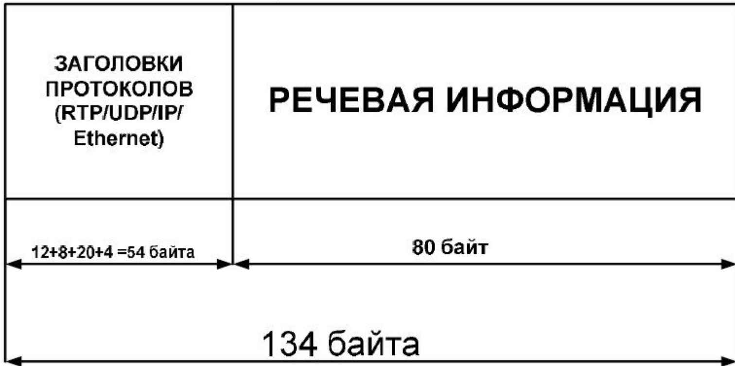
Рис. 13. Формат кадра G.711, передаваемого по IP сети
