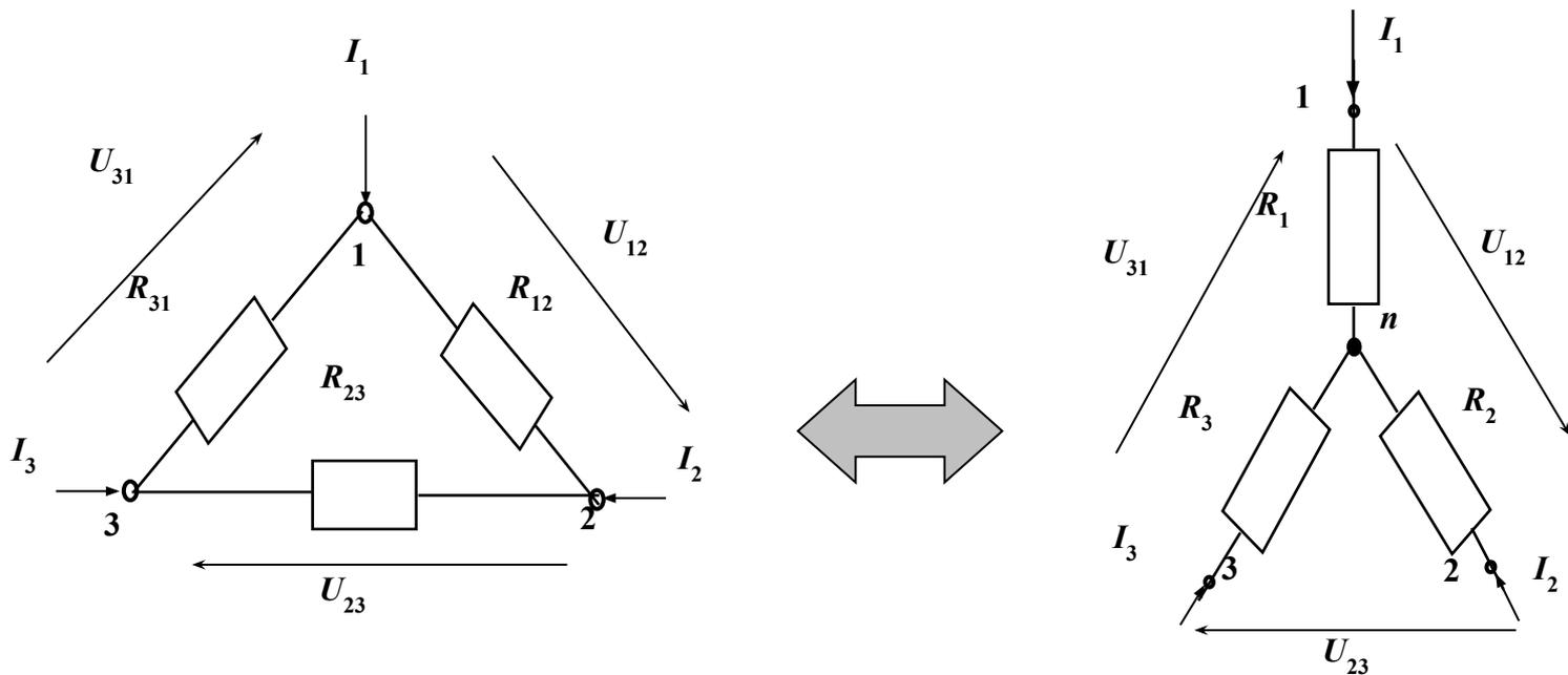
Рассмотрим преобразование “треугольника” в “звезду”. Для “треугольника” запишем уравнение баланса напряжений (второй закон Кирхгофа):
