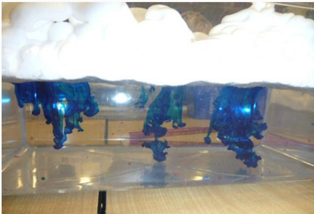
Вывод: краска просачивается сквозь пену и опускается на дно за счет большей плотности.
