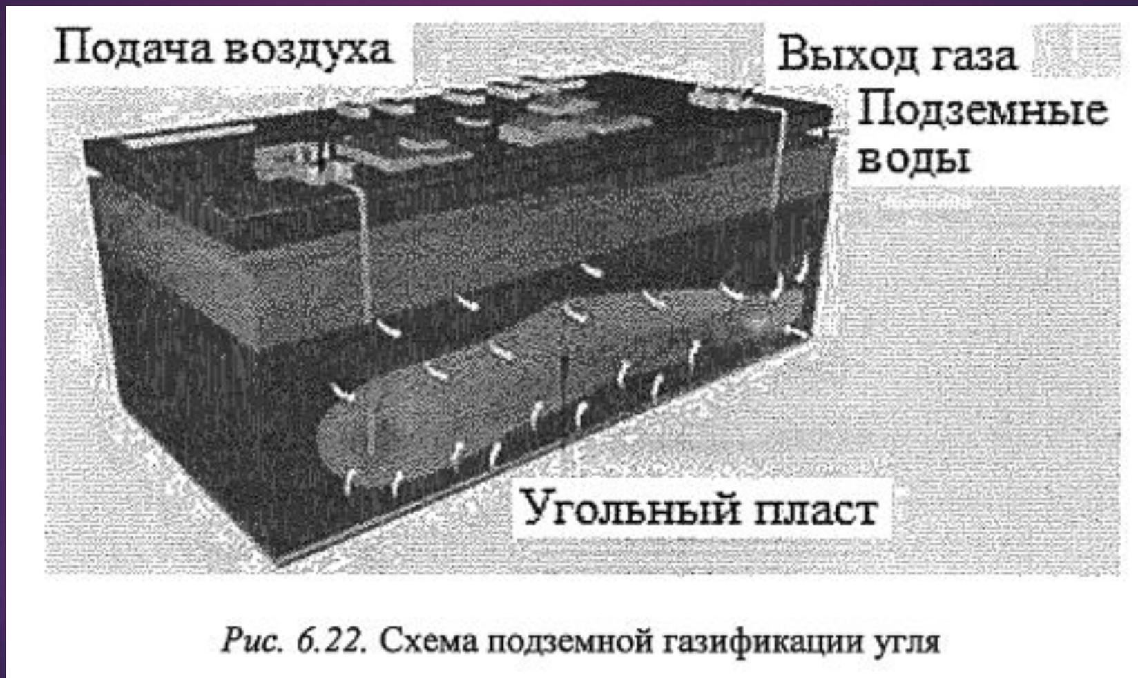
Рис. 6.22. Схема подземной газификации угля
