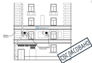
**Запрет по монтажу** наружного блока на фасаде зданий, чаще всего выходящие на центральные улицы. Покупатель заранее, до выполнения работ, оформляет разрешение на монтаж кондиционера.
