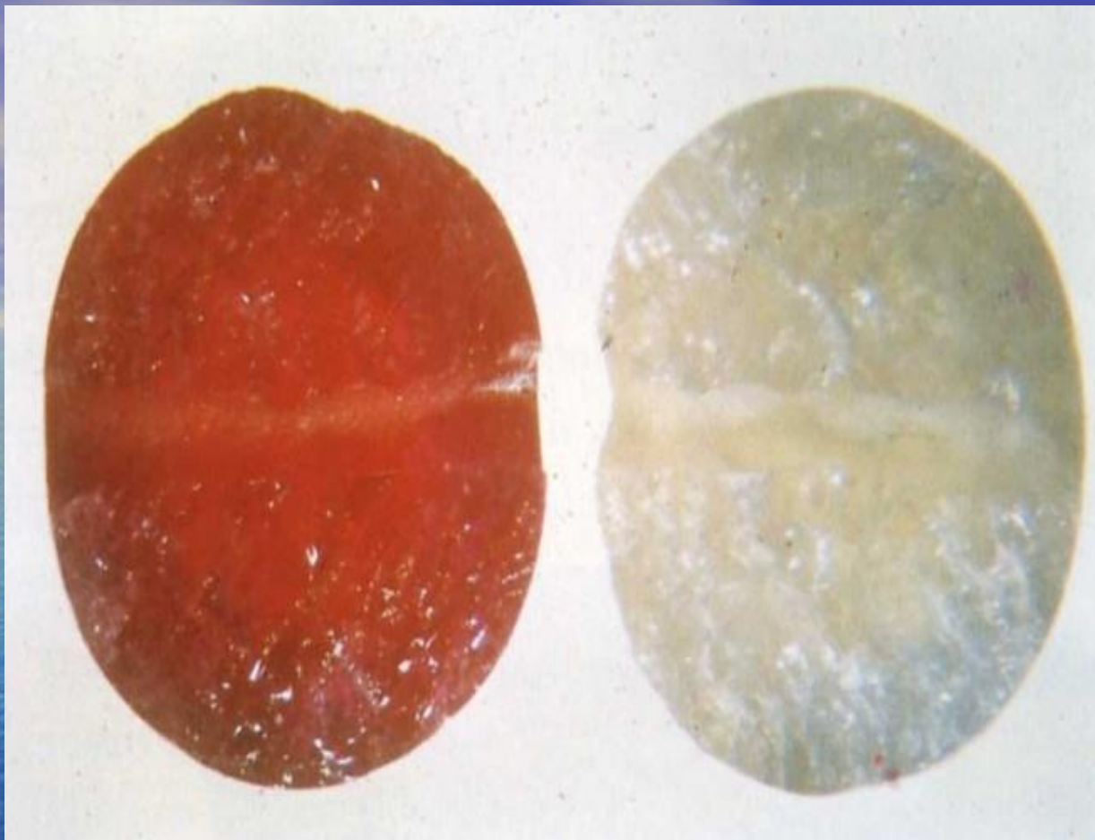
Рис № 71. Бусина снятая с ожерелья и распиленная пополам. Слева — прокрашенная половина, справа — обесцвеченная в ацетоне.
