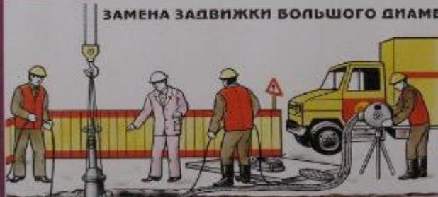
Во время замены задвижки давления в газопроводе контролируют U-образным манометром с жидким заполнением. Прибор подключают на расстоянии не более 100 м от колодца. Контроль загазованности среды ведется непрерывно.
