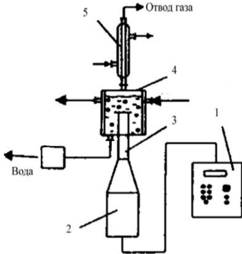
Рис. 2 – Установка обезвоживания и обессоливания нефти: 1 – генератор УЗ колебаний; 2 – магнитострикционный преобразователь; 3 – волновод; 4 – патрубок; 5 – холодильник; 6 – реактор
