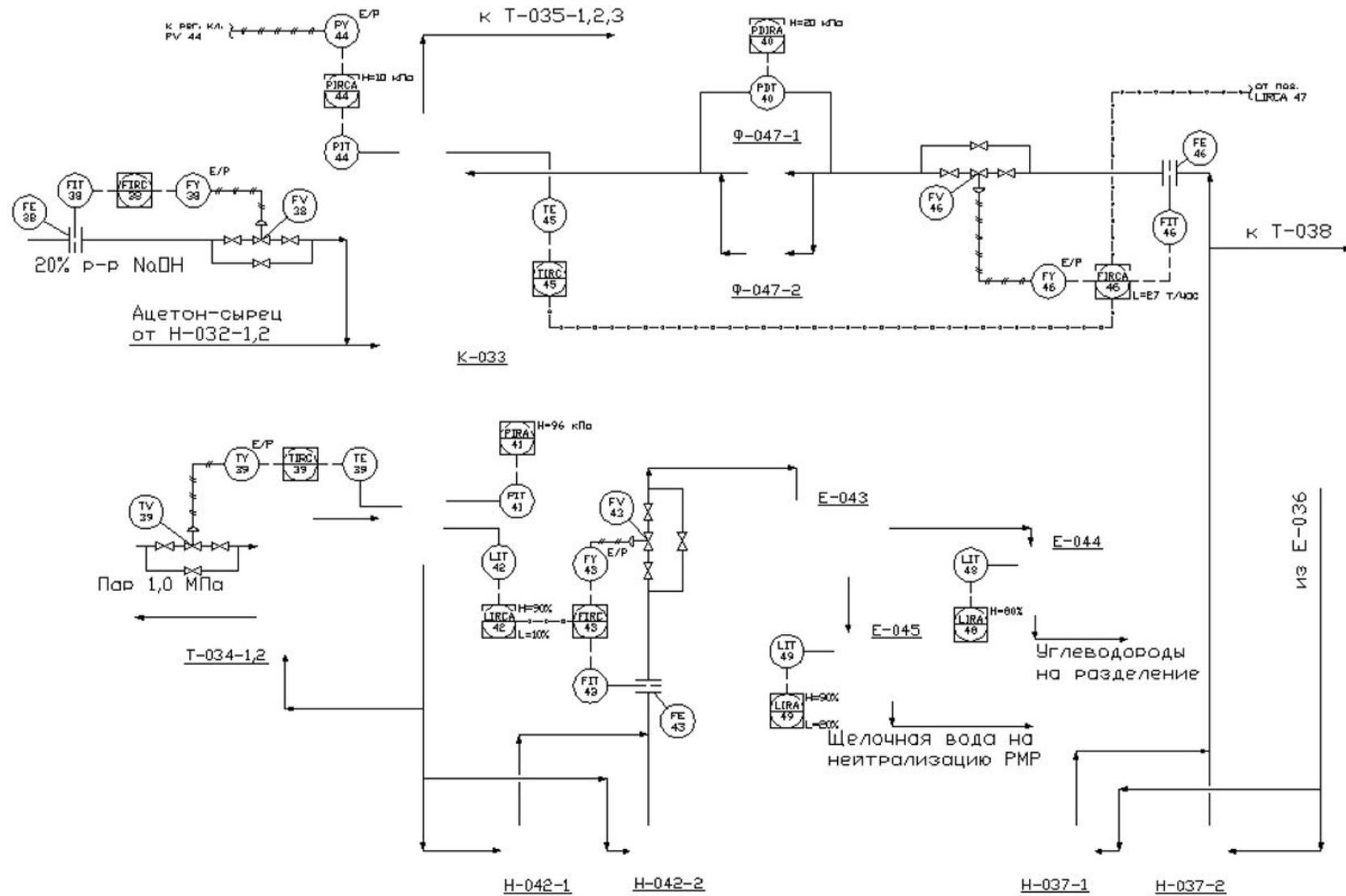
**Рис. 1 - P&ID – схема выделения товарного ацетона**
