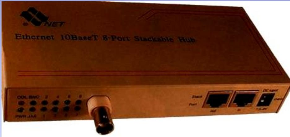
**Концентраторы (HUB или Switch)** - служат для соединения компьютеров в сети. Концентратор может иметь различное количество портов подключения (обычно от 8 до 32).
