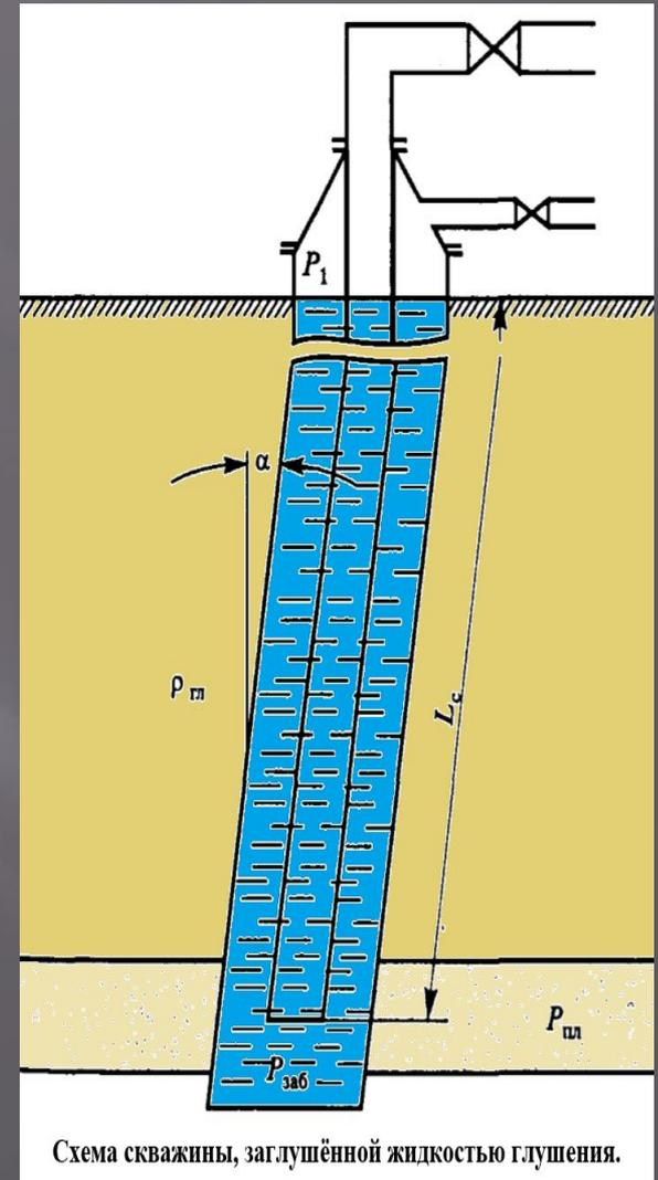
Схема скважины, заглушённой жидкостью глушения.
