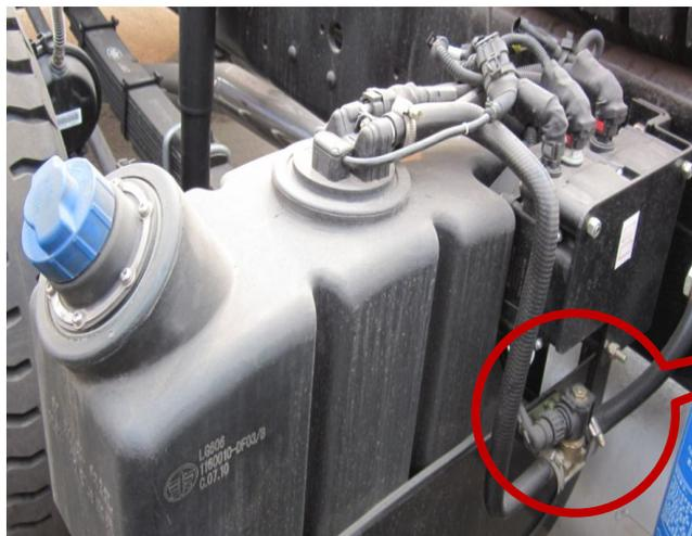
Соединение патрубка подвода охлаждающей жидкости 2хф14
