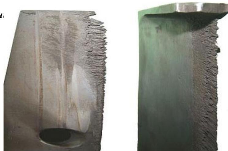
*Износ лопаток паровых турбин*
