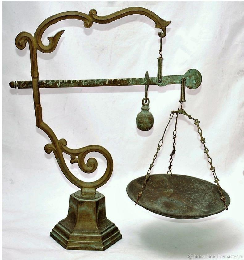
Римлянам приписывают изобретение принципиально иной системы измерения веса - такой, при которой передвигается гиря, а точка опоры и положение привеса остаются неизменными. Один из самых ранних образцов безмена найден в Помпеях. У римского приспособления, в отличие от современного прибора, имелись две шкалы и две ручки в виде крюков
