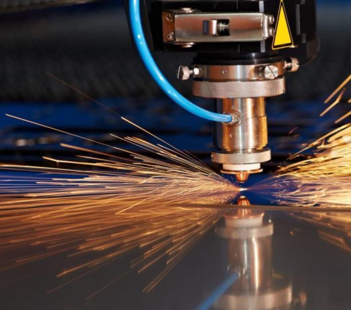
Возникает эффект так называемого кинжалного или глубинного проплавления, в результате которого образуется узкий и глубокий канал.
