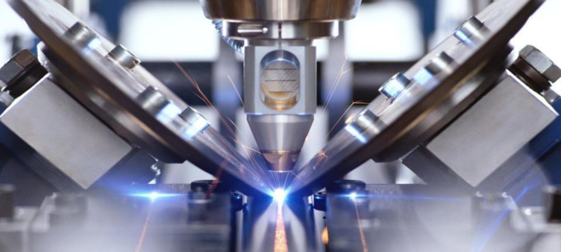
Лучевые методы обработки материалов обеспечивают энергию, плотность которой на несколько порядков выше чем у других тепловых источников.
