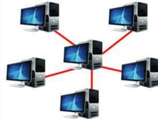
Каждый компьютер в сети подключен к **центральной точке** обмена данными и **использует свою отдельную линию связи**
