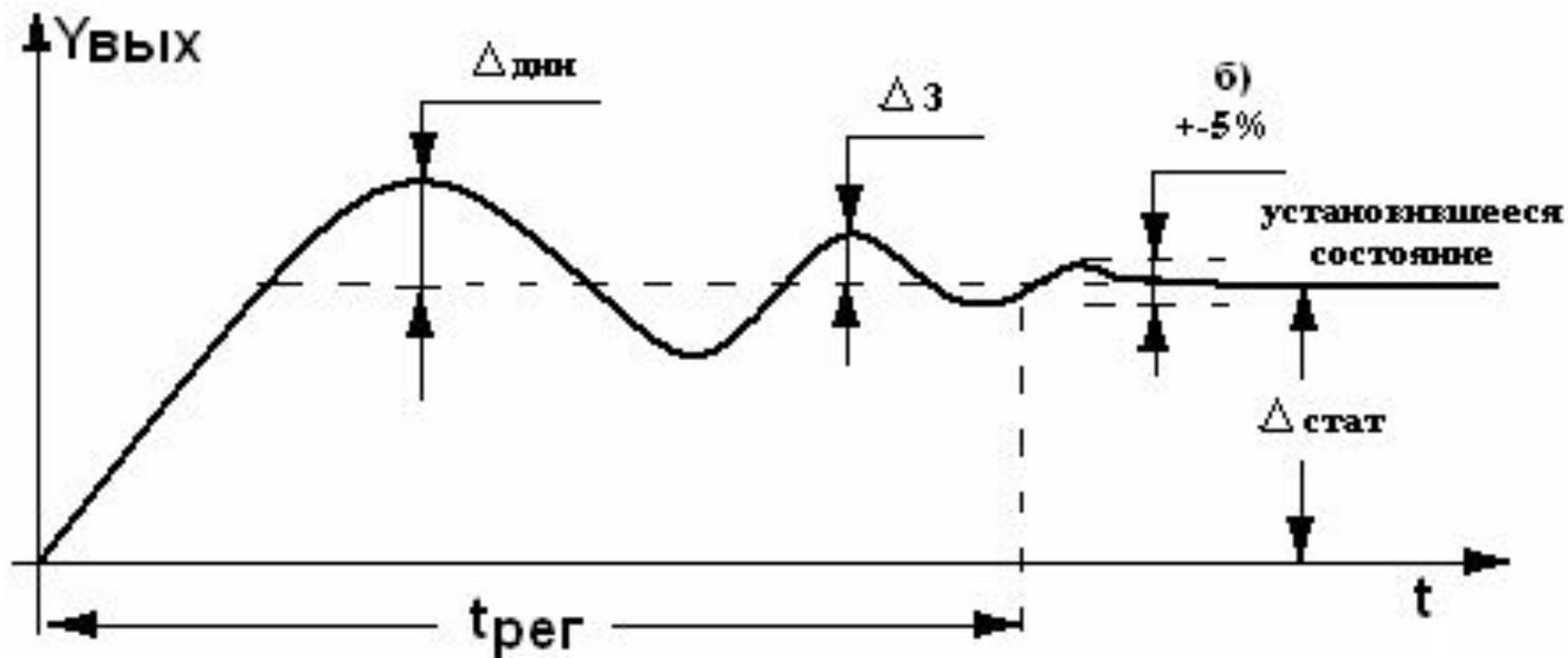
**Точность** - статическая ошибка определится непосредственно через уравнение ПФ. Для установившегося режима производные дифференциального уравнения обращаются в нуль, поэтому приравняв нулю в определённом уравнении оператор Лапласа ( $p = 0$ ), получим выражение для статической ошибки. Если  $e(\infty) = 0$ , то САР является *астатической*, если  $e(\infty) \neq 0$ , то – *статической*.
