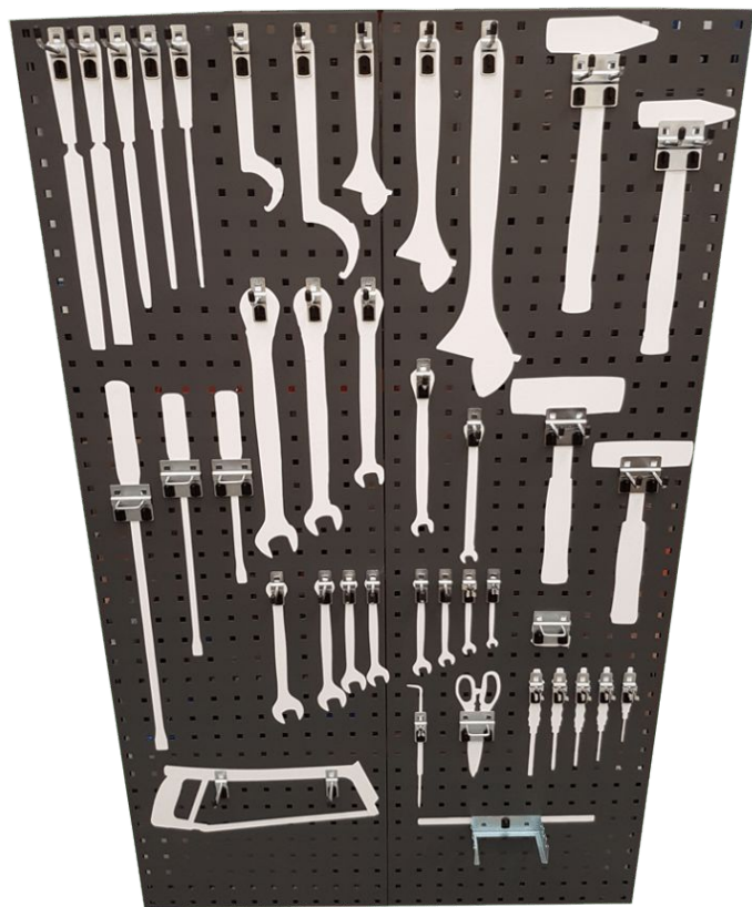
Примеры размещения слесарного инструмента в соответствии с принципами 5С
