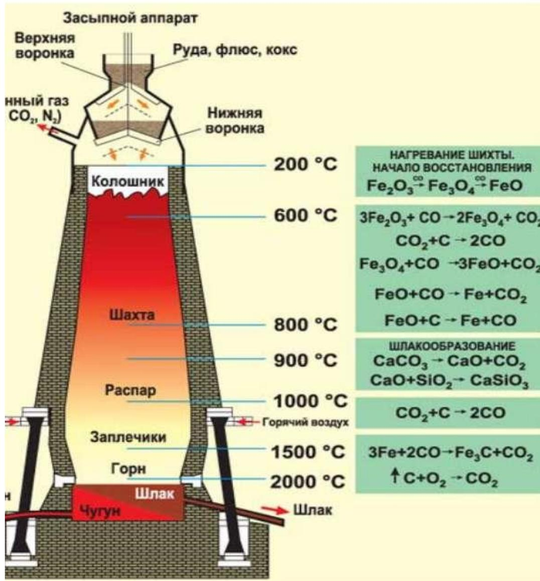
Чугун — сплав железа с углеродом (и другими элементами). Содержание углерода в чугуне не менее 2,14% (до 4,5%)
