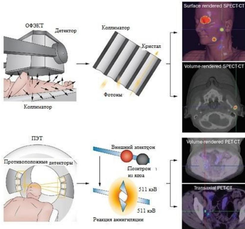
ОФЭКТ-КТ - используется радиофармпрепарат, в котором при акте радиоактивного распада излучается 1 гамма-квант, регистрируемый гамма-камерой, оснащенной коллиматором (*устройством для получения параллельных пучков частиц*)
