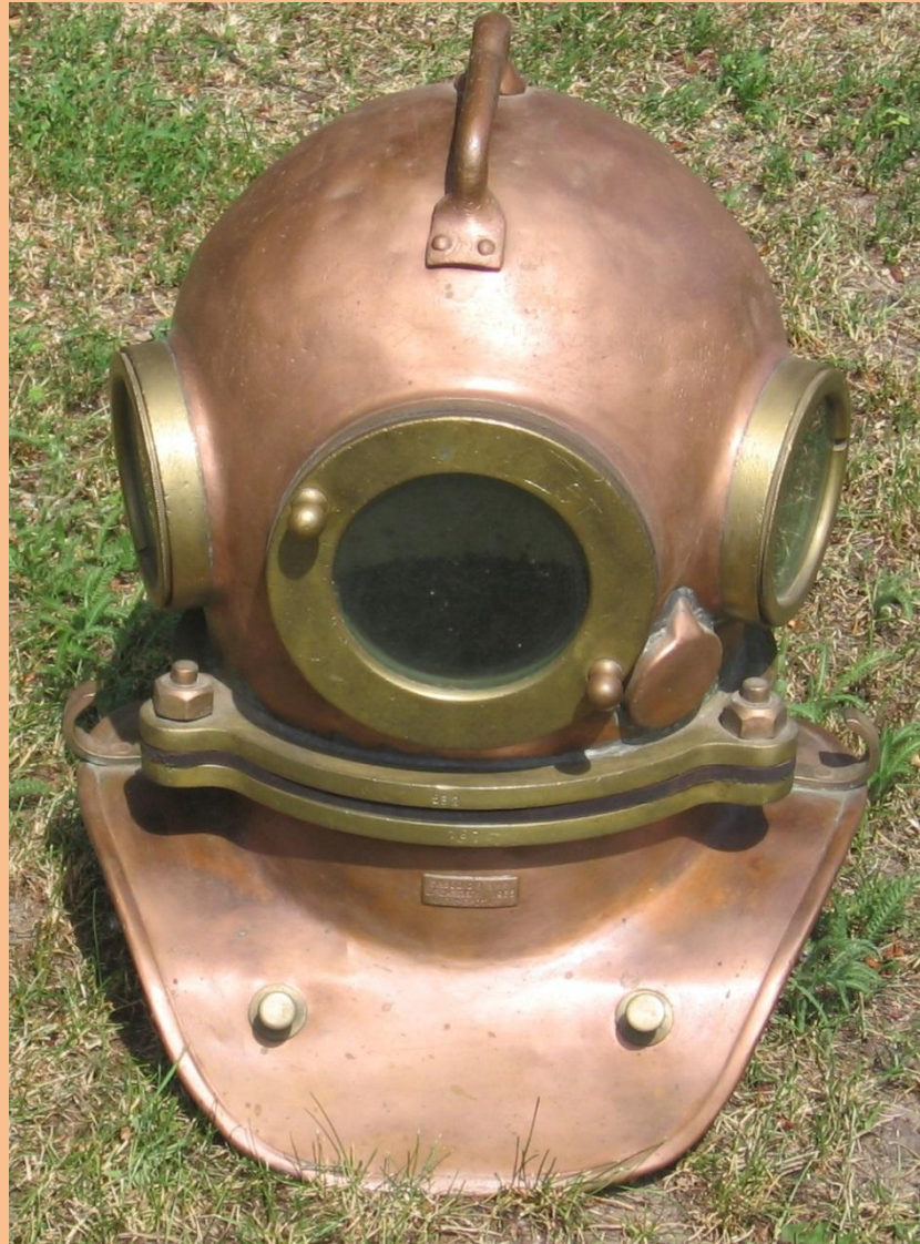
российский водолазный костюм Трёхболтовка.
