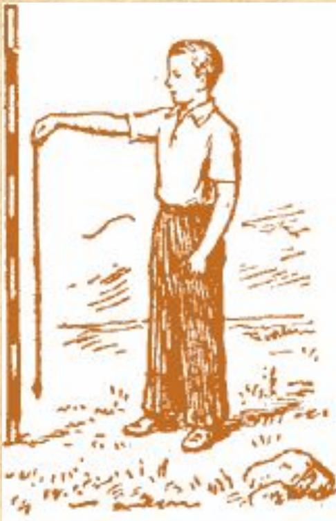
Необходимо, чтобы все вехи стояли вертикально. Правильность вертикального направления проверяется с помощью отвеса. Отвес — это шнур, на конце которого имеется небольшой груз.
