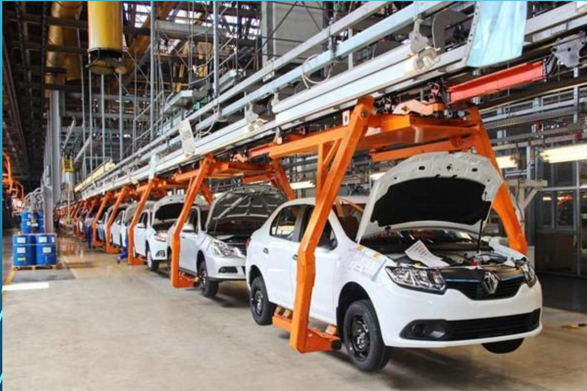
сборочный конвейер на автомобильном заводе
