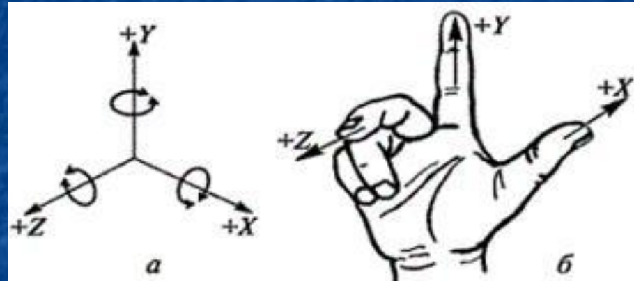
Рис. чпу.1 Расположение осей координат в станках с ЧПУ (а); правосторонняя система координат (б)
