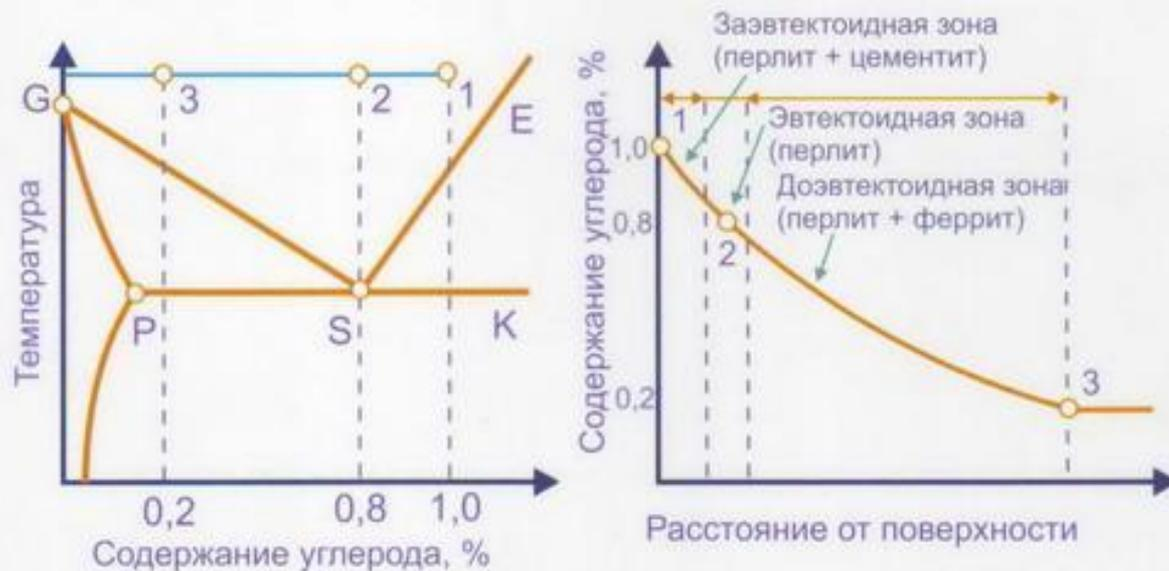
**Цементация в твердом карбюризаторе.** Процесс осуществляют при 910-930°C в карбюризаторе, состоящем из **древесного угля, 20-25% BaCO<sub>3</sub> и 3-5% CaCO<sub>3</sub>.**
