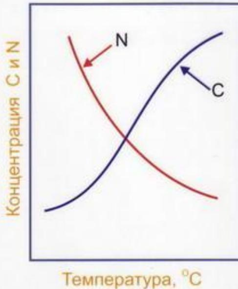
Различают высокотемпературную и низкотемпературную нитроцементацию.
