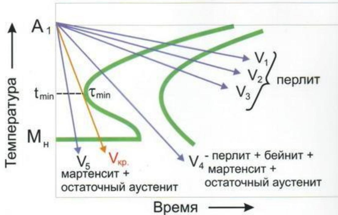
$V_{кр.}$  - критическая скорость закалки - минимальная скорость охлаждения, при которой весь аустенит будет переохлажден до мартенситного интервала
