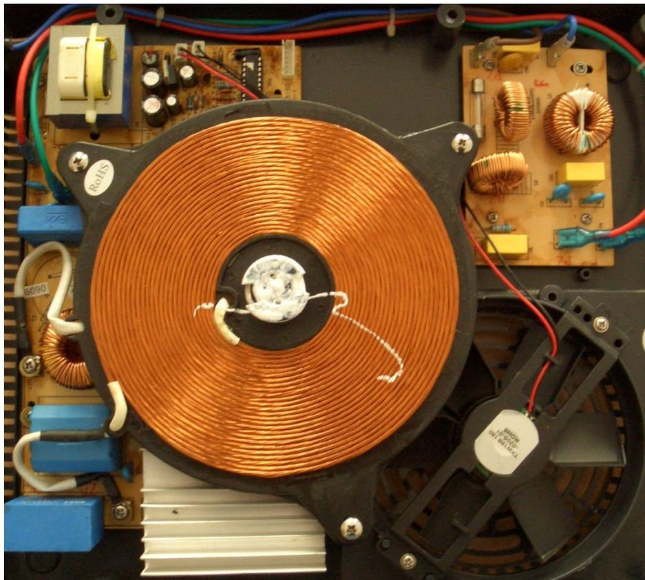
Конструкция плиты состоит из корпуса, платы управления на микроконтроллере, к которому подключен датчик температуры и схема управления силовой частью, силовая часть с мощным выпрямителем и импульсным регулятором (обычно на IGBT-транзисторе)
