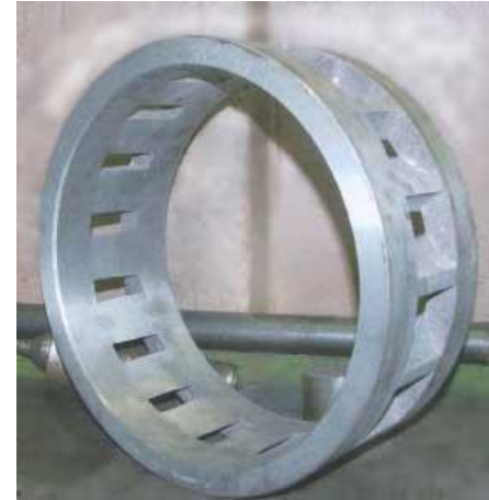
Износостойкий чугун (роторный измельчитель)
