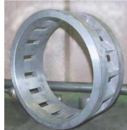
Износостойкий чугун (роторный измельчитель)
