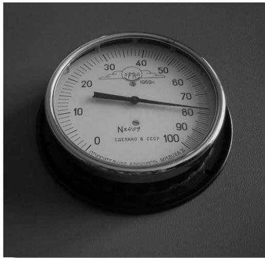
Рис. 3. Гигрометр бытовой
