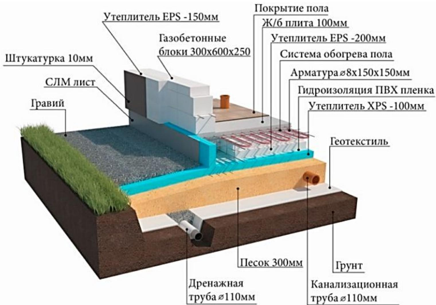
1. Песчано-щебневая или гравийная подушка, которая выполняет функции дренажной системы и служит в качестве своеобразного демпфера при сезонных колебаниях почвы.
