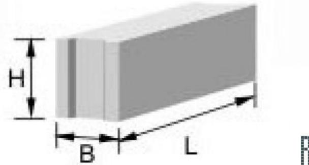
Типоразмеры **ФБС** : длина - от 400 до 2400 мм., ширина - 300, 400, 500, 600 мм., высота - 300, 400, 500, 600 мм. Размеры фундаментных блоков заложены в их наименовании, указанной в дециметрах: **фбс 24 4 6**
