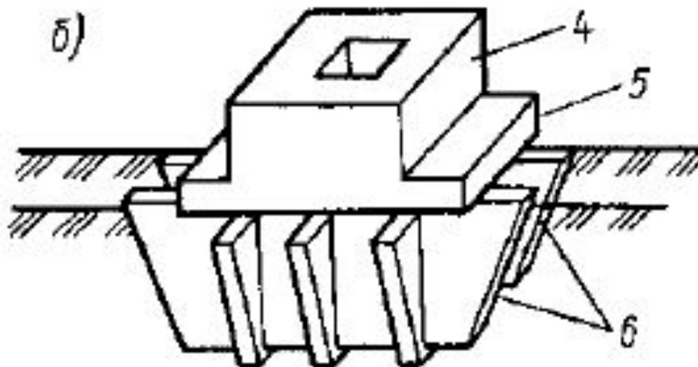
*4 – подколонник; 5 – плитная часть; 6 – бетонные пластины;*
