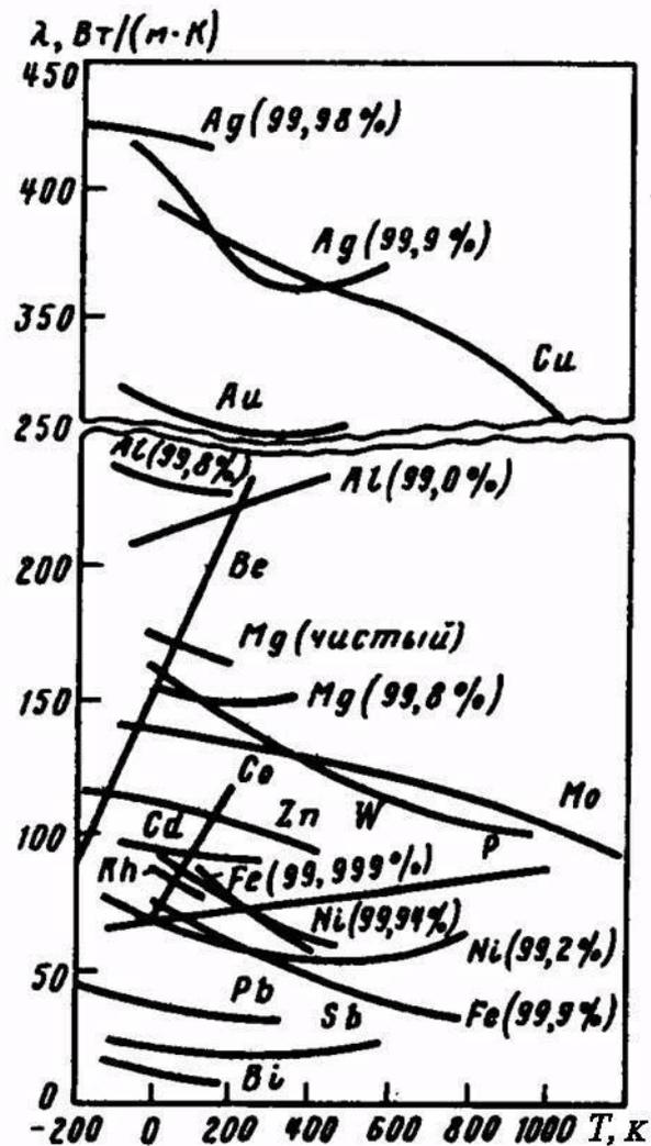
Рис. 2. Изменение теплопроводности металлов и их сплавов в зависимости от температуры
