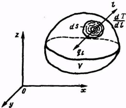
Рис. 6. К выводу дифференциального уравнения теплопроводности
