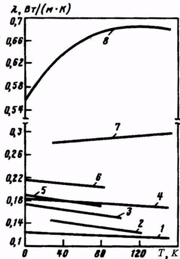
Рис. 3. Изменение теплопроводности некоторых жидкостей в зависимости от температуры:
