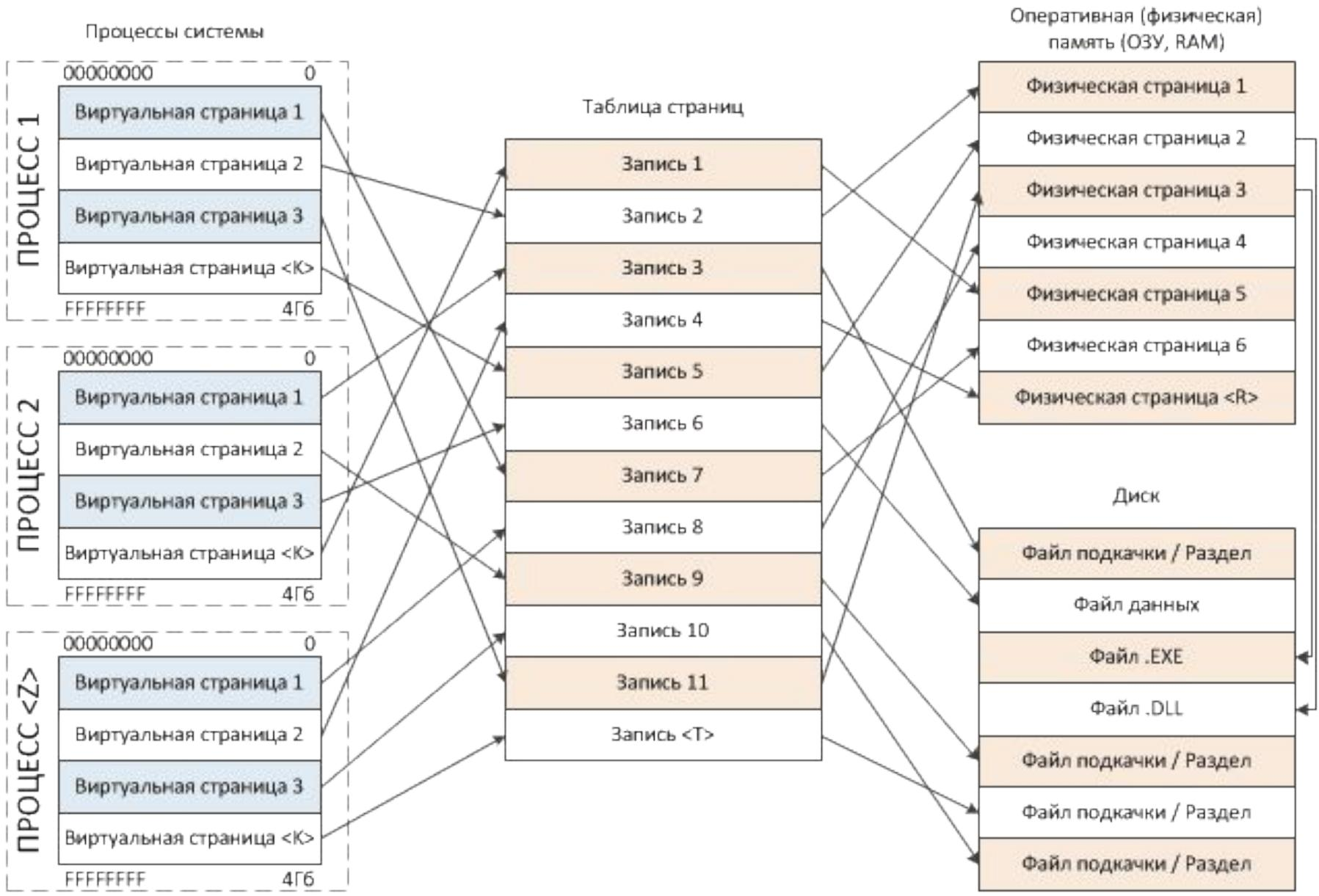
Синхронизация между виртуальными и физическими страницами памяти поддерживается аппаратно на уровне процессора, и называется трансляцией адресов. Данная технология "на лету" преобразует виртуальный адрес в физический и обратно. Отсюда следует немаловажный вывод:
