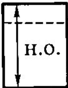
Нить основы (н.о.) должна проходить параллельно линии, проведенной посередине вдоль детали
