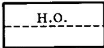
Нить основы (н.о.) должна проходить параллельно линии, проведенной посередине вдоль детали
