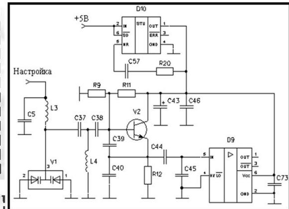
ГУН с малошумящим стабилизатором напряжения
