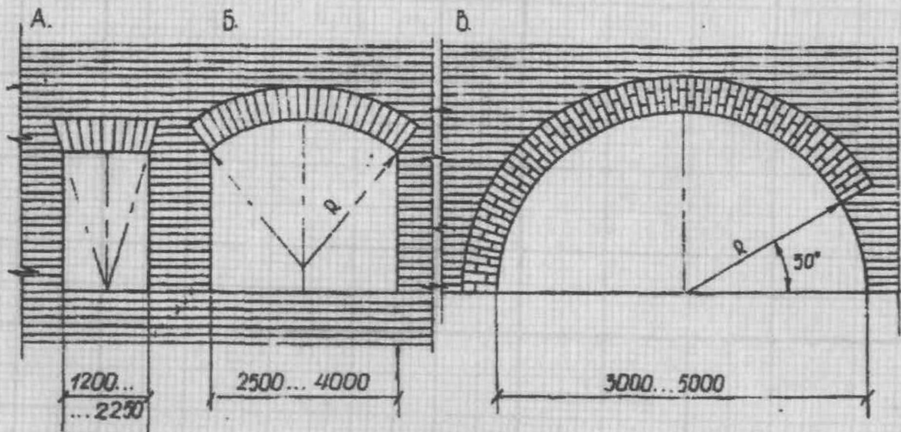
I Конструкция дверных и оконных проемов
