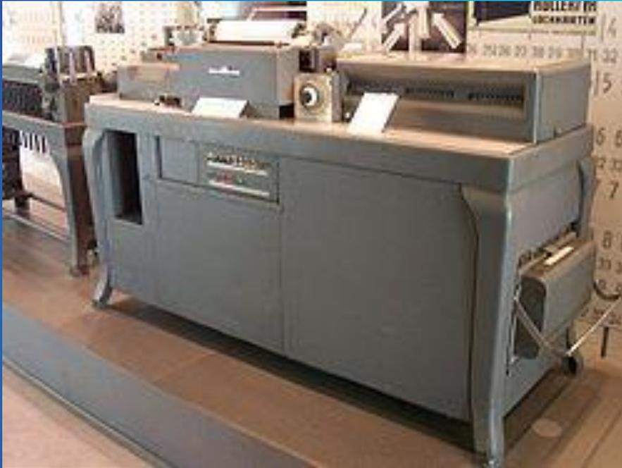
**Табулятор** — электромеханическая машина, предназначенная для автоматической обработки (суммирования и категоризации) числовой и буквенной информации, записанной на перфокартах, с выдачей результатов на бумажную ленту или специальные бланки.
