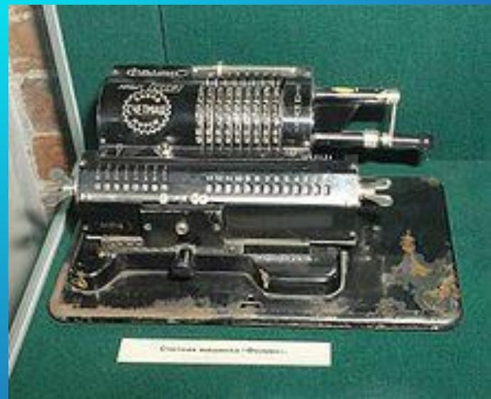
**Арифмометр** (от греч. ἀριθμός — «число», «счёт» и греч. μέτρον — «мера», «измеритель») — настольная (или портативная) механическая вычислительная машина, предназначенная для точного умножения и деления, а также для сложения и вычитания
