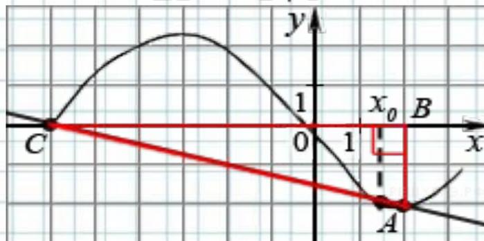
На рисунке изображен график функции  $y = f(x)$  и касательная к этому графику в точке абсциссой, равной 3. Найдите значение производной этой функции в точке  $x = 3$ .
