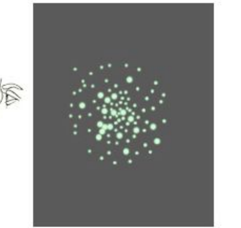
Фотографии люминесцирующего экрана при отсутствии золотой фольги в потоке \alpha - частиц и при ее внесении в поток
