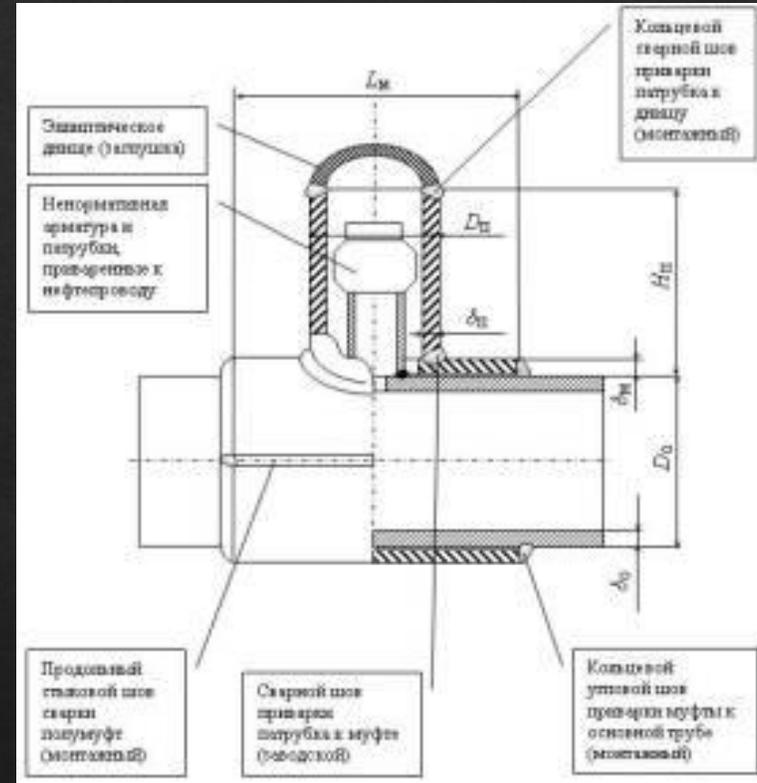
Схема разрезного тройника заводского исполнения с эллиптическим днищем (заглушкой) при устранении несанкционированных врезок
