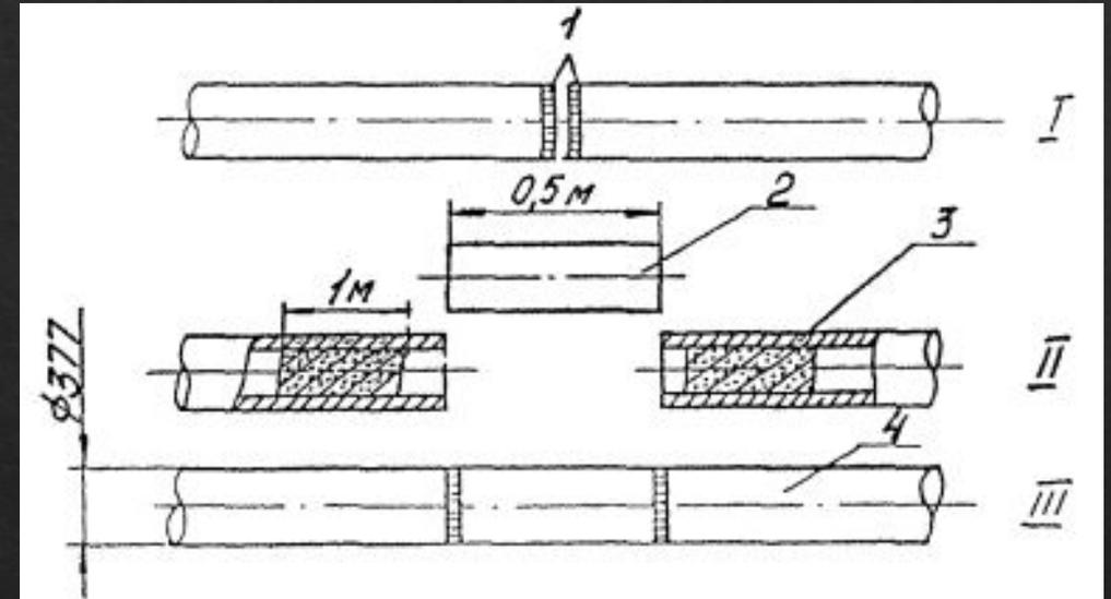
I - разорвавшаяся по сварному стыку труба;
