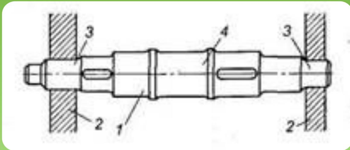
Рис.1. Прямой вал: 1 — вал; 2 — опоры вала; 3 — цапфы; 4 — шейка
