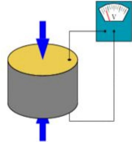
**Обратный пьезоэффект** - если прикладывать к пластине переменное электрическое напряжение, то кристалл начинает сжиматься и расширяться (изменять геометрические размеры), с частотой прикладываемого напряжения.
