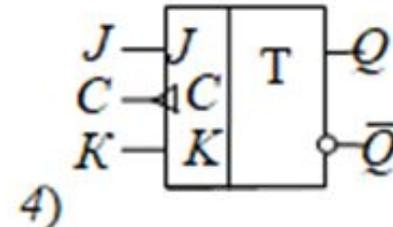
Укажите условное графическое обозначение синхронного  $T$ -триггера, выполненного на основе  $JK$ -триггера
