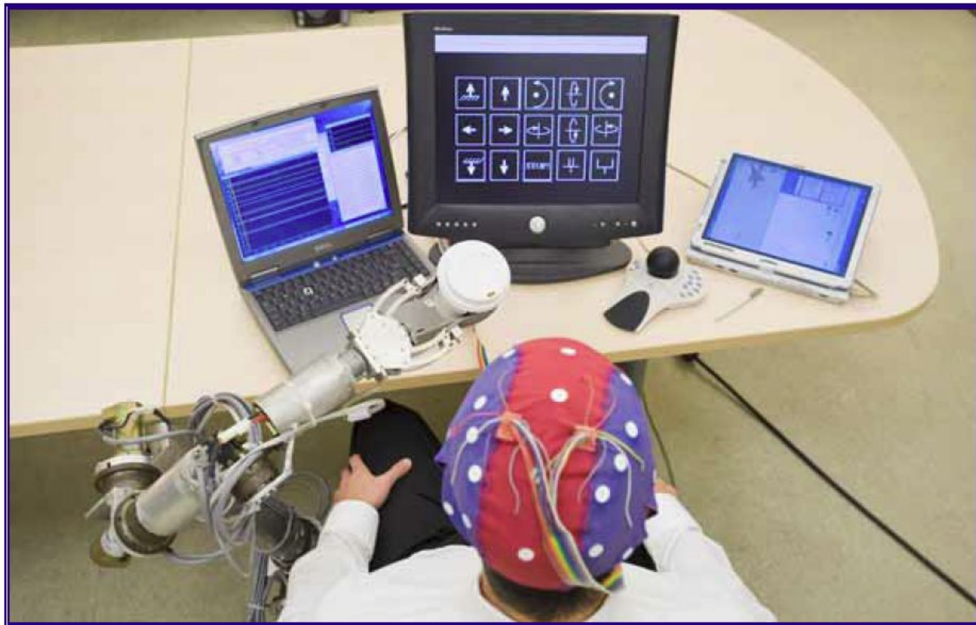
Рис.3. Управління роботом (протезами) за допомогою інтерфейсу «людина-комп'ютер»
