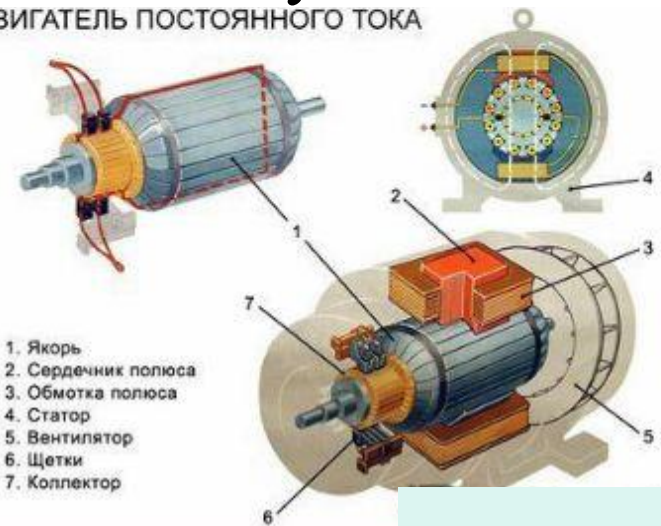
ПРИНЦИП УСТРОЙСТВА ГЕНЕРАТОРОВ ЭЛЕКТРИЧЕСКОГО ТОКА
