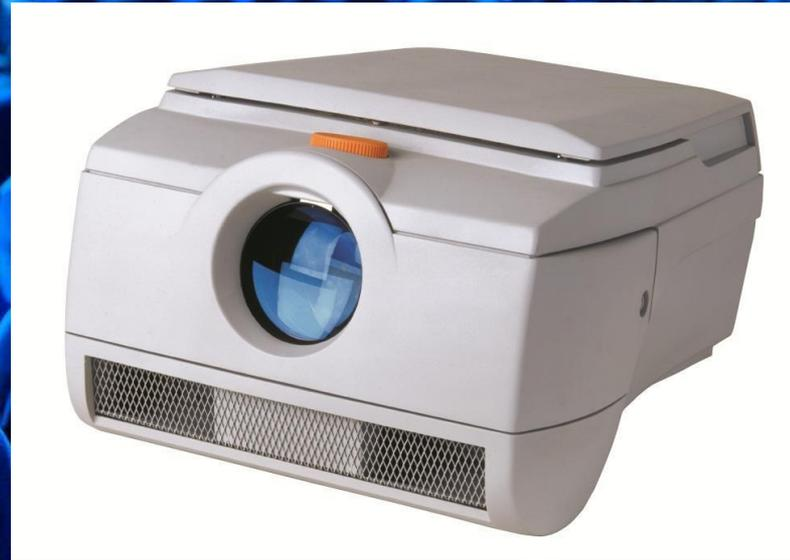
**Визуалайзер** - портативная высокочувствительная видеокамера, предназначенная для оперативной демонстрации иллюстраций и документов, может использоваться докладчиком, заменяя графопроектор, слайд - и эпипроектор.
