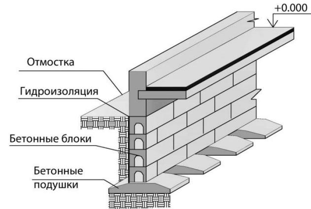
Гидроизоляционная обработка на высоту 500 мм от уровня грунта
