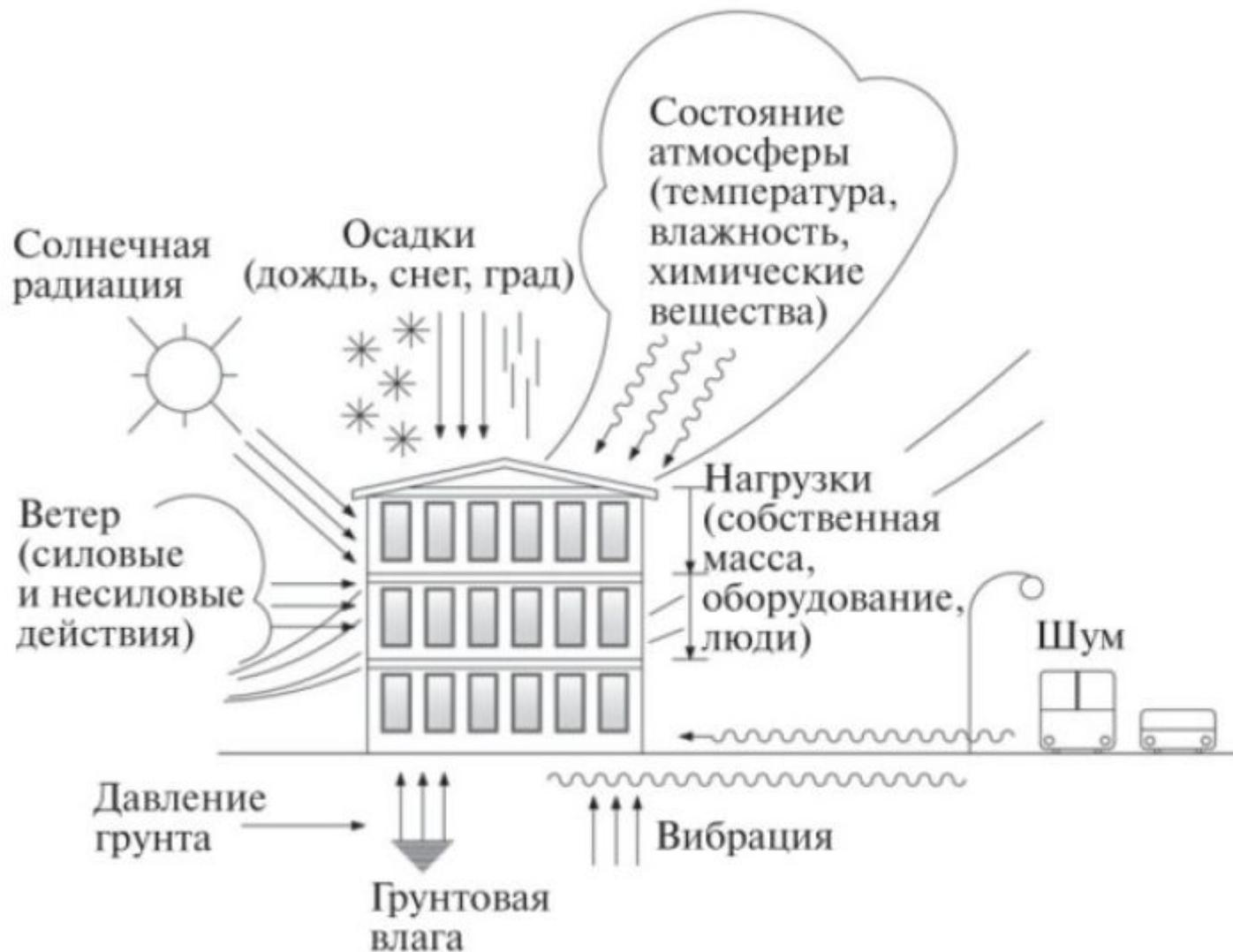
Рис. 1. Нагрузки и воздействия на здание
