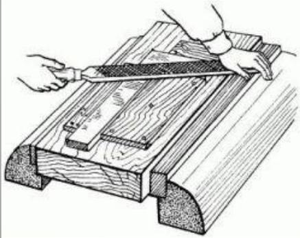
**Опиливание** – это слесарная металлообработка , во время которой происходит снятие материала с поверхности детали с помощью напильника
