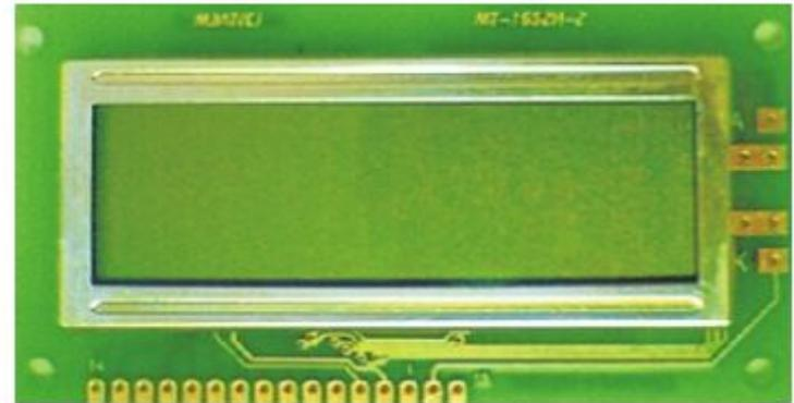
Жидкокристаллический модуль MT-16S2H состоит из БИС контроллера управления и ЖК панели. Контроллер управления аналогичен HD44780 фирмы HITACHI и KS0066 фирмы SAMSUNG. Модуль выпускаются в двух вариантах: со светодиодной подсветкой и без нее. Внешний вид приведен на рисунке 1.
