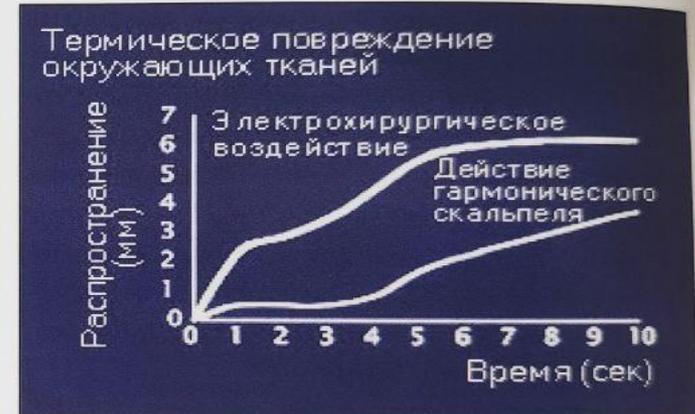
Рис. 3.16. Термическое повреждение окружающих тканей: сравнение действия гармонического скальпеля и электрохирургического инструмента
