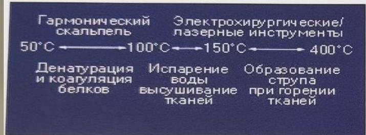
Рис. 3.15. Коагуляция с использованием ультразвуковой технологии: сравнительные показатели температур и изменений, происходящих в тканях, при воздействии гармонического скальпеля и электрохирургических/лазерных инструментов
