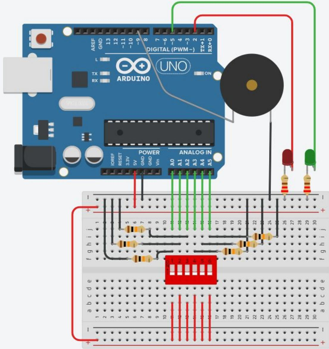
Имея исходную схему добавьте пьезоэлемент и ещё одну (ложную) комбинацию тумблеров в код, при которой загорается зелёный светодиод и звучит сирена (или любой другой звук из пищалки), сигнализирующий о вызове полиции.
