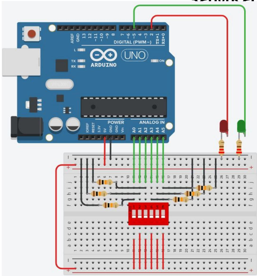
Подтягивающие резисторы на пины A0 – A5 крайне необходимы во избежание короткого замыкания между **5V** и **GND** при включении тумблеров.
