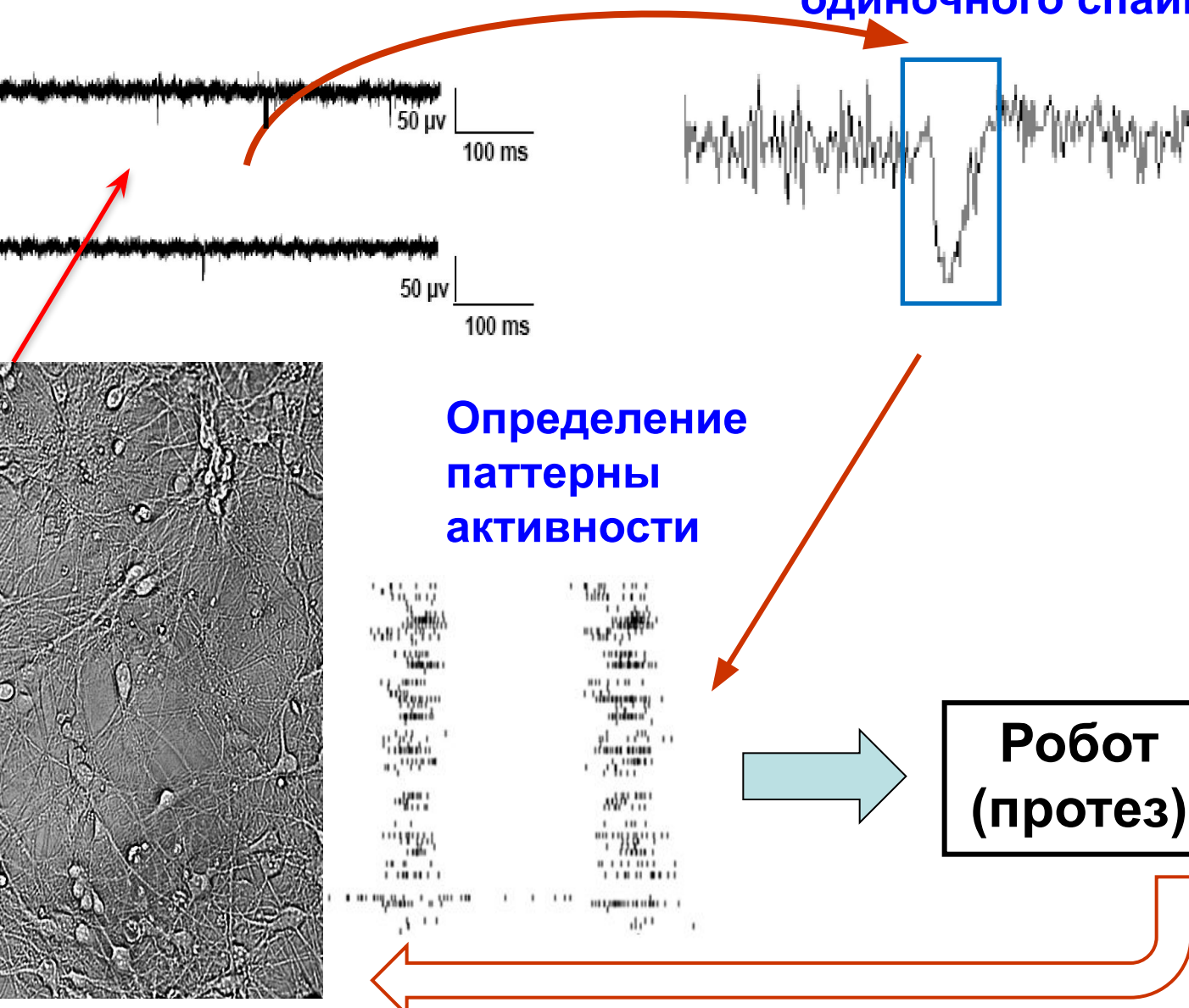
Нейронная сеть (живая ткань) на мультиэлектродной матрице
